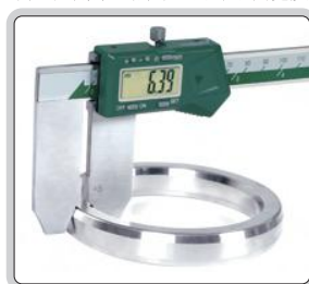
测量八角形金属环垫的环平面宽度
