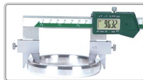
测量八角形金属环垫的节径
